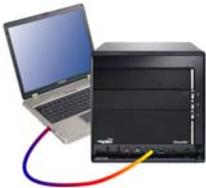
Das Übertragen von Dateien zwischen zwei PCs war noch nie so einfach wie mit der innovativen Speed-Link-Technologie – einfach beide Systeme mit einem gewöhnlichen USB-Kabel (Typ A zu A) verbinden und Daten übertragen!
