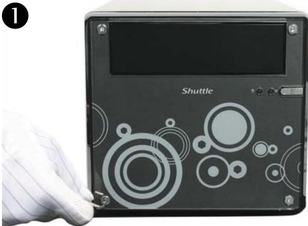
**1** Lösen Sie die vier Schrauben, damit die Frontblende gelöst werden kann. Entfernen Sie die transparente Abdeckung und das Bild.
