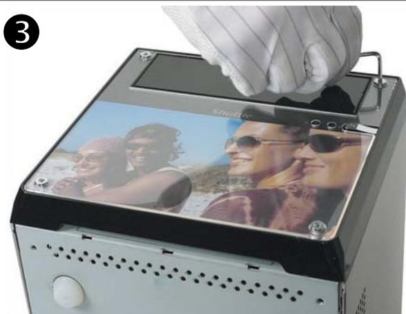
**3** Richten Sie das neue Bild und die transparente Abdeckung auf die Befestigungslöcher aus und schrauben es dann mit den vier Schrauben wieder vorsichtig fest.
