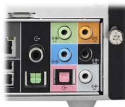
Les Shuttle XPCs disposent en général d'un **contrôleur audio 8 canaux à haute définition** avec de nombreuses entrées et sorties analogiques et numériques. Les connecteurs numériques S/PDIF sont en partie optionnels.
