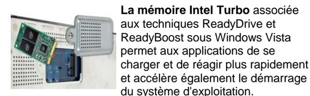
La **mémoire Intel Turbo** associée aux techniques ReadyDrive et ReadyBoost sous Windows Vista permet aux applications de se charger et de réagir plus rapidement et accélère également le démarrage du système d'exploitation.
