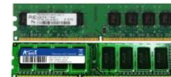
DDR2/DDR3: les deux types de modules possèdent 240 broches, mais les encoches de détrompage sont différentes.
