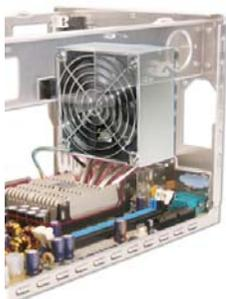
Les Shuttle XPC de format cubique offrent la **même puissance que les PC de bureau ordinaires, ils sont cependant environ trois fois plus petits**. Afin de pouvoir garantir un refroidissement suffisant de ces petits boîtiers PC, il a été nécessaire de développer et intégrer un système de refroidissement spécifique pour les Shuttle XPC.
