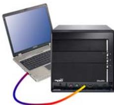
Le transfert de fichiers entre deux PC n'a jamais été aussi simple qu'avec la technologie innovante Speed-Link-Technologie – il suffit de relier les deux systèmes par un câble USB (type A-A) et de transférer les données !
