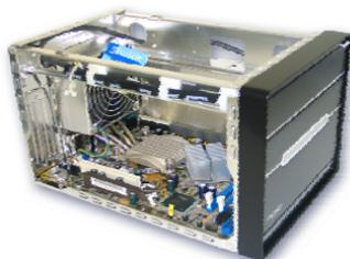
Le **Shuttle XPC Barebone** est un système de base de grande qualité avec un boîtier en Aluminium, une carte-mère une alimentation et un système de refroidissement à caloducs (sauf: séries T et K). Tous ces composants sont optimisés et prémontés de sorte que l'intégration d'autres composants relève d'un jeu d'enfants.
