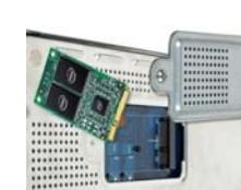
**Intel Turbo Memory** zusammen mit ReadyDrive und ReadyBoost unter Windows Vista bewirkt, dass Anwendungsprogramme schneller laden bzw. reagieren und auch das Booten des Betriebssystems beschleunigt werden kann.
