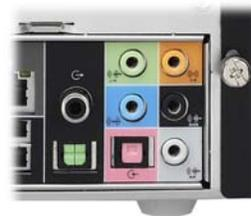
Aktuelle Shuttle XPCs verfügen in der Regel über einen integrierten **8-Kanal High Definition Audio-Controller** (außer K-Serie) mit zahlreichen analogen und digitalen Ein- und Ausgängen. Die digitalen S/PDIF-Anschlüsse sind z.T. optional.
