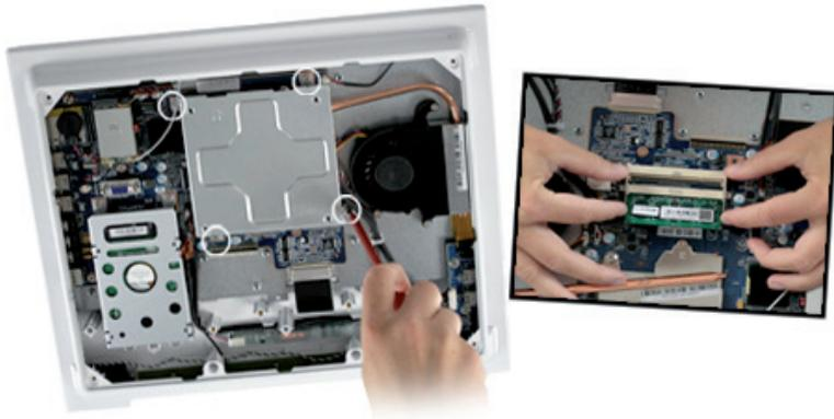
**6** Une seconde protection est fixée par 4 vis supplémentaires. Cette partie n'est à démonter que si l'on désire accéder aux emplacements de la mémoire vive. Pour remplacer ou ajouter un module, écarterez avec précaution les clapets latéraux des emplacements. Veillez à bien orienter le module avant son insertion.
